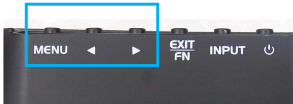
●LCD1730 の操作ボタン（背面より見た図）
